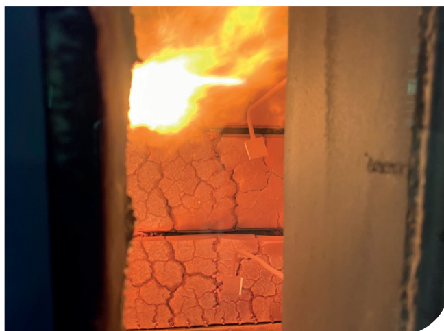
Abb. 1: Blick nach ca. 15 min von hinten in den Brandraum: Die Temperatur beträgt zu diesem Zeitpunkt ca. 700° C. Die Beplankung aus PAVATEX Isolair brennt und verformt sich, bleibt aber an der Konstruktion und schützt so das Tragwerk und die dazwischen befindliche Naturfaserdämmung. In unseren Produkten werden keinerlei Brandschutzmittel verwendet.
