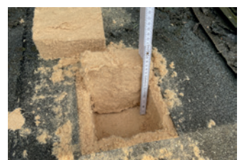
1.12 Die Dachöffnung erfolgte bis auf 4 cm über Dampfsperreebene und überzeugte mit hervorragenden Messwerten in verschiedenen Bereichen des Dämmstoffquerschnitts.
