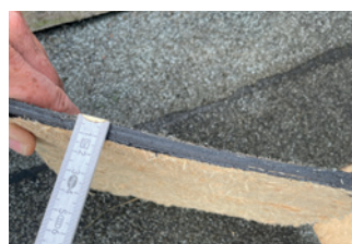
1.10 Zweilagige bituminöse Abdichtung im Querschnitt mit flächigem Haftverbund zur Holzfaserdämmung.
