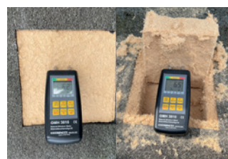
1.11 Feuchtemessung mit Einstichmessgerät. Nahezu keine Änderung der Messwerte, die Holzfaserdämmung ist „staubtrocken“. 1. Messung direkt unter der Abdichtung. 2. Messung in verschiedenen Bereichen.
