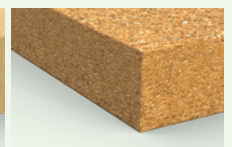
PAVAFLEX CONFORT 36 Rohdichte ~55 kg/m 3 WLS 038 Dicken 40–240 mm
